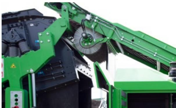
Mit der Reinigungsbürste für das Zuführband bleiben weniger Anhaftungen am Gurt hängen. Leckmaterial unterhalb der Maschine wird dadurch minimiert.
