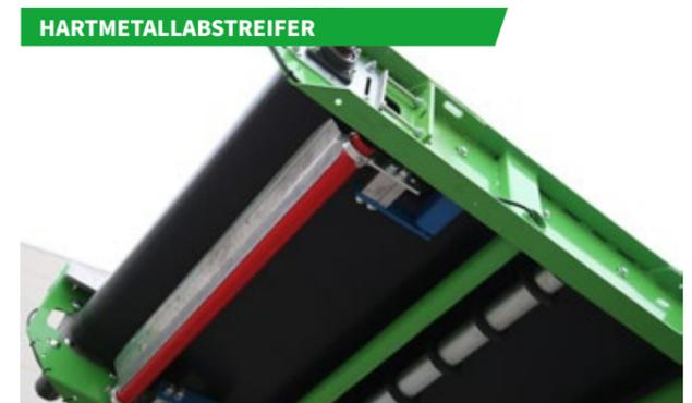
Mittels Hartmetallabstreifern werden die Förderbänder der Kombi-Siebmaschinen von klebrigen und/oder stark haftenden Materialien, wie z.B. Lehm, Ton, Gips, Zement gereinigt.
