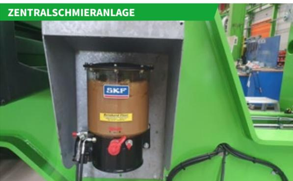
Die automatische Zentralschmierung stellt durch ständige Erneuerung des Schmierfilms die zuverlässige Einsatzbereitschaft der Siebmaschine sicher.
