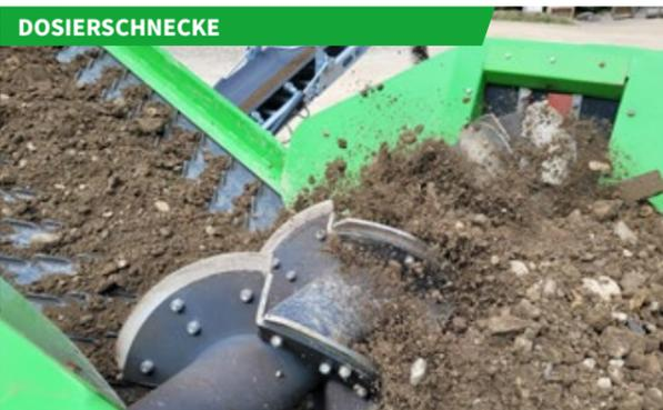
Die Dosierschnecke sorgt für eine gleichmäßige Zuführung des Inputmaterials auf das Steigband/Siebeck und erhöht somit die Siebleistung.
