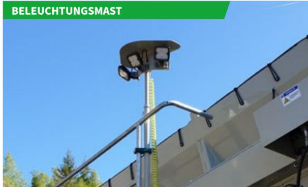
Zur ganzheitlichen Beleuchtung großer Flächen können die Kombi-Siebmaschinen ohne großen Aufwand mit zusätzlichen Beleuchtungsmasten ausgestattet werden.
