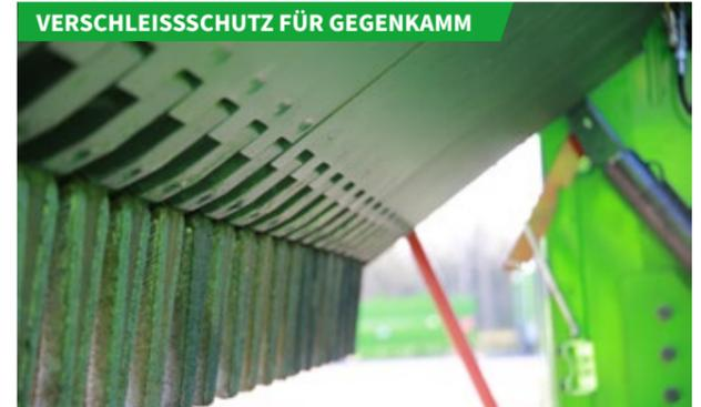
Für eine signifikante Erhöhung der Betriebsdauer kann der Gegenkamm optional mit einem Verschleißschutz versehen werden.
