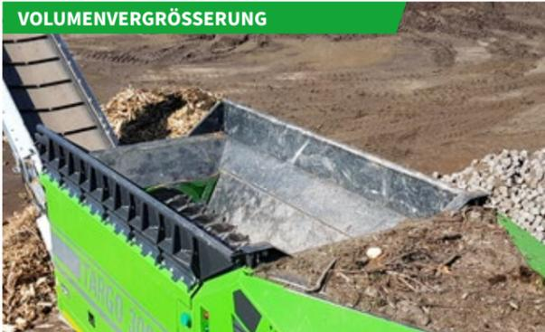
Die Volumenvergrößerung vereinfacht und beschleunigt das Beladen der mobilen Maschine zur Optimierung des gesamten Zerkleinerungsprozesses.
