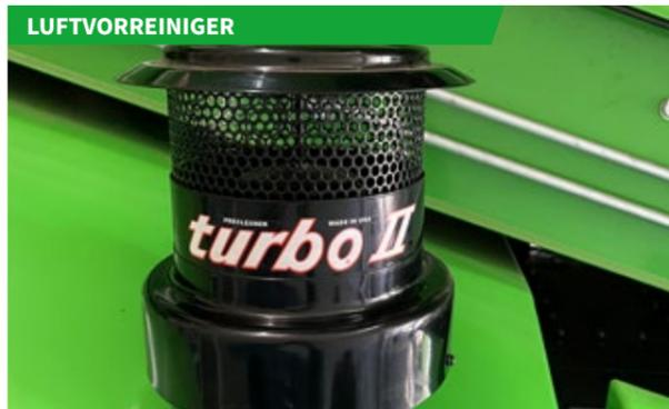
Bei staubigen und schmutzbelasteten Umgebungsbedingungen schützt der optionale Luftvorreiniger den Luftfilter des Dieselmotors vor übermäßiger Verschmutzung.
