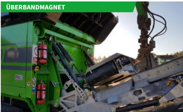
Ohne den laufenden Förderprozess zu stören, entfernt der angebrachte Überbandmagnet Eisen- und Stahlbestandteile aus dem aufzubereitenden Material, wie z.B. Bauabfall.
