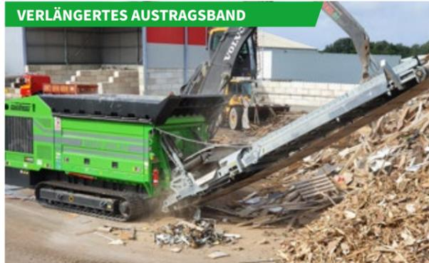
Ein verlängertes Austragsband ermöglicht besonders große Schüttkegel und die direkte Beladung des Zerkleinerers von Transportfahrzeugen aus.
