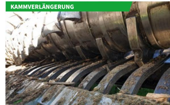
Die optionale Kammverlängerung erhöht die Effektivität des TARGO bei der gleichmäßigen Zerkleinerung diverser Reststoffe von Altholz bis Sperrmüll.
